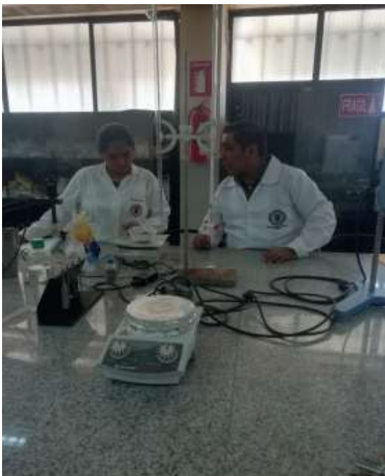
Figura 30. Registro fotográfico de la toma del peso inicial con la balanza de precisión de las muestras del suelo. Sanchez, 2023.
