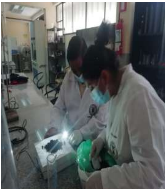
Figura 31. Toma del peso final de las muestras tamizadas con la balanza de precisión de las muestras del suelo Sanchez,2023.
