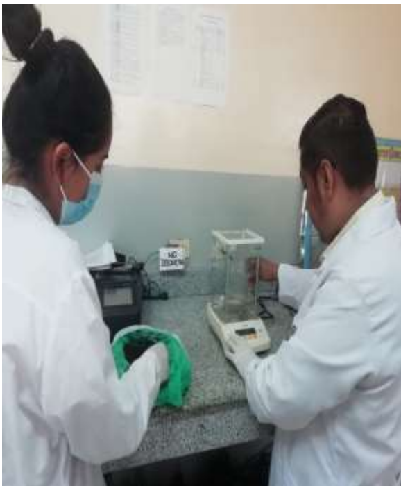
Figura 29. Registro fotográfico de la toma del peso inicial con la balanza analítica del vaso de precipitado Sanchez, 2023.
